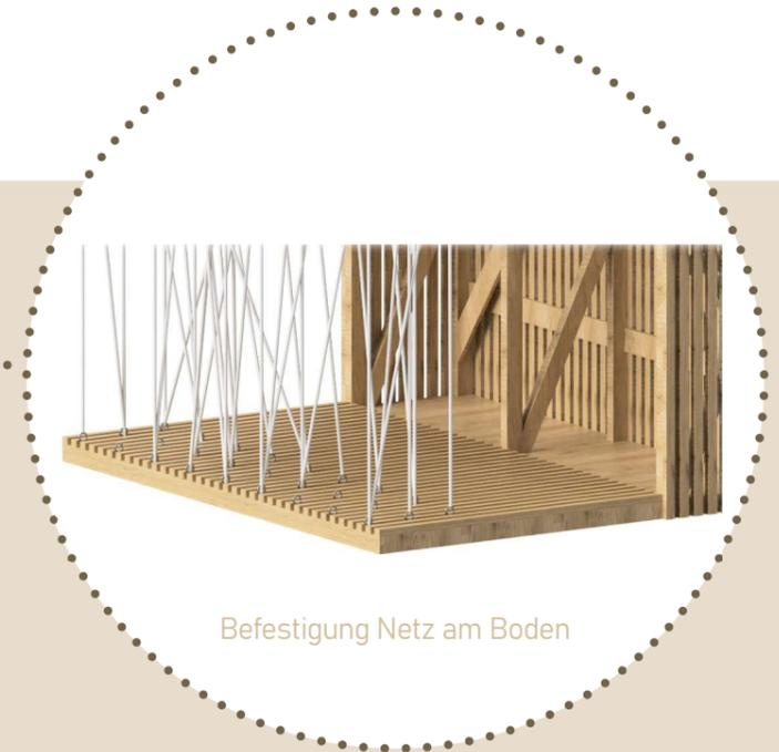
Befestigung Netz am Boden
