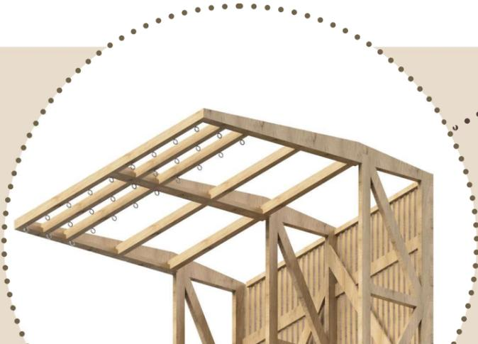
Dachkonstruktion / Befestigung Netz am Dach
